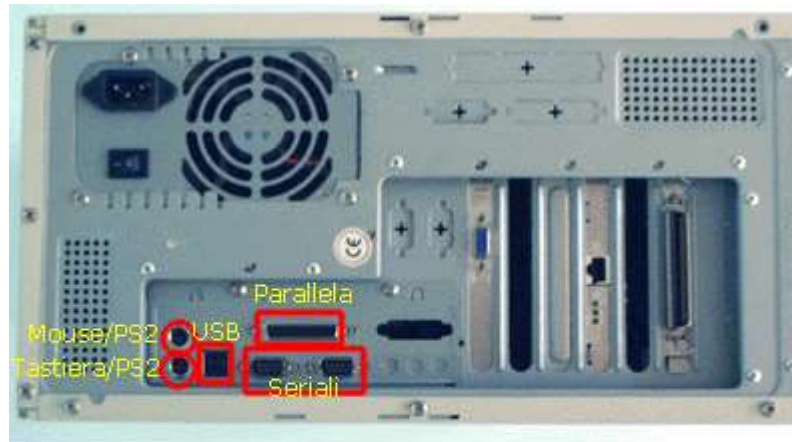
Le porte di comunicazione sul retro del PC
