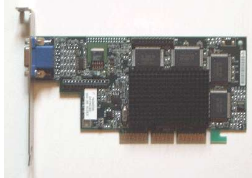
La scheda video (in basso il connettore per lo slot AGP)
