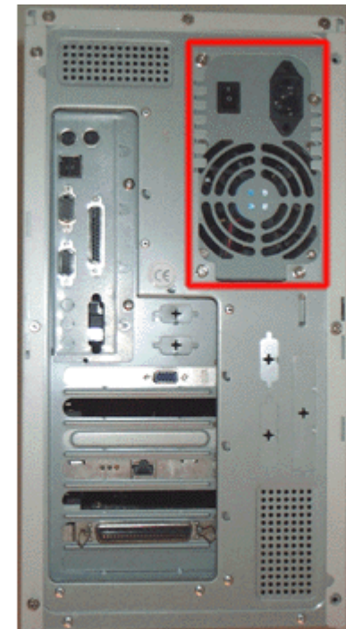
La ventola per raffreddare l'alimentatore, posta sul retro del PC
