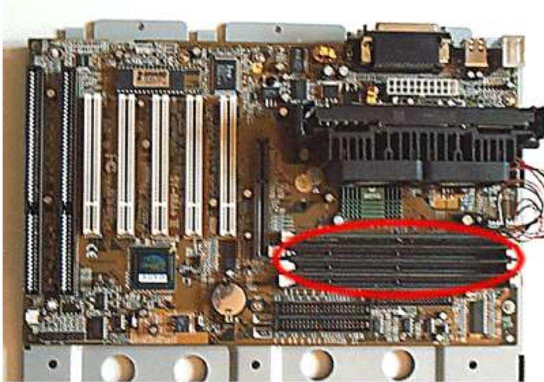
Gli slot per l'alloggiamento della RAM (DIMM)
