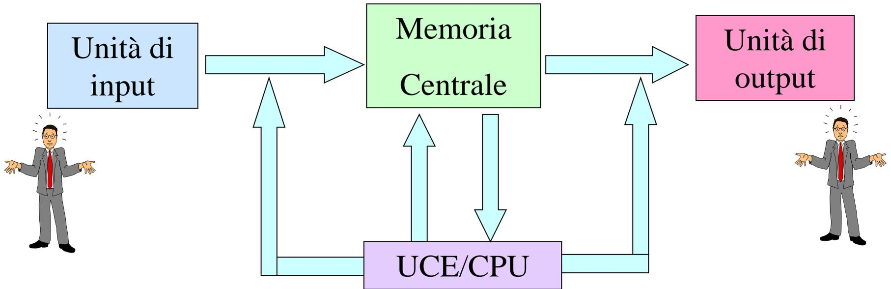
Le linee di flusso, che collegano l'UCE con gli In e gli Out, indicano che il trasferimento dei dati avviene sotto la supervisione dell'UCE
