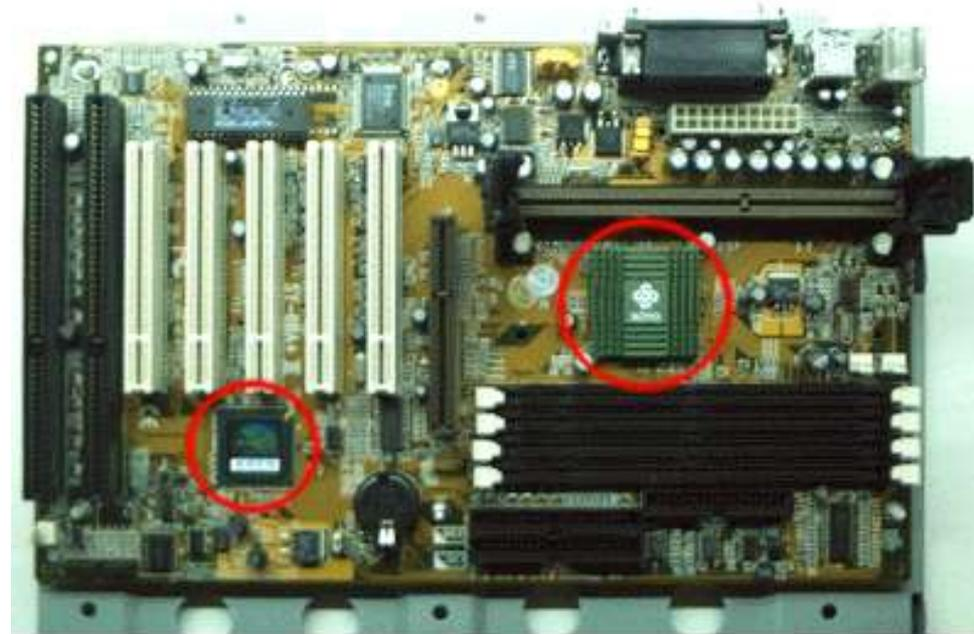
Il chipset è costituito da una serie di circuiti adibiti al controllo delle diverse componenti montate sulla scheda madre
